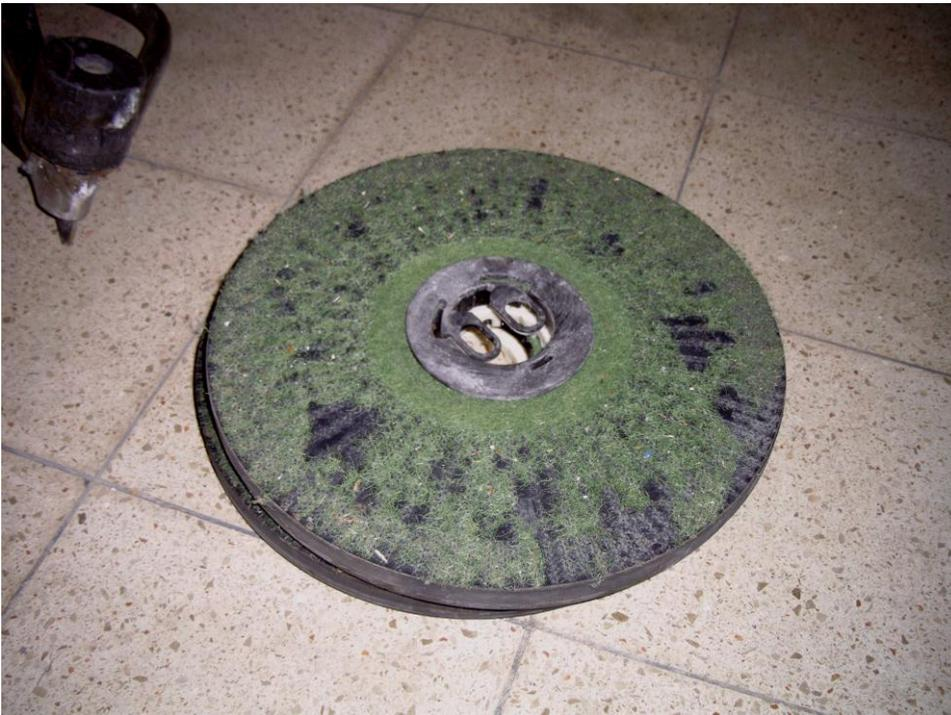
Diese noch festhaftenden Reste einer ehemals grünen Padscheibe befanden sich auf dem Treibteller unter einer im täglichen Einsatz befindlichen Scheuersaugmaschine (SSM). Das Bedienpersonal bemerkte es nicht und verursachte sukzessiv Kratzer am Betonwerkstein u.a. Bodenbelägen durch die Kunststoffhalterung in Verbindung mit dem Anpressdruck der SSM.
